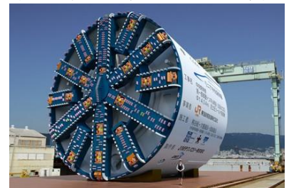
(直径15mのシールドマシン)
